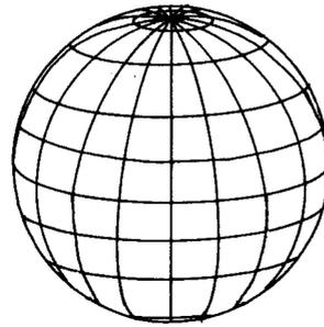
Рис. 15. Гауссову сферу можно разделить на элементы по меридианам и широтам. Однако получающиеся элементы имеют неодинаковые площади и совмещаются друг с другом только при определенных поворотах вокруг оси, проходящей через полюсы.
