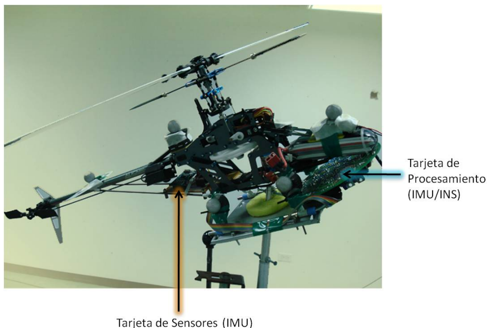
Figura 7.29: Detalle de la instrumentación de la IMU
