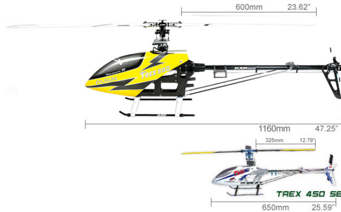
Figura 5.12: Comparación de dimensiones entre T-REX 450 y 600
