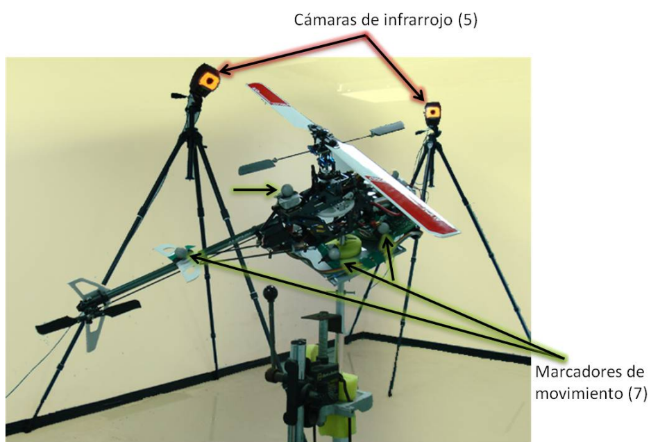
Figura 7.28: Detalle de la instrumentación para el análisis de movimiento
