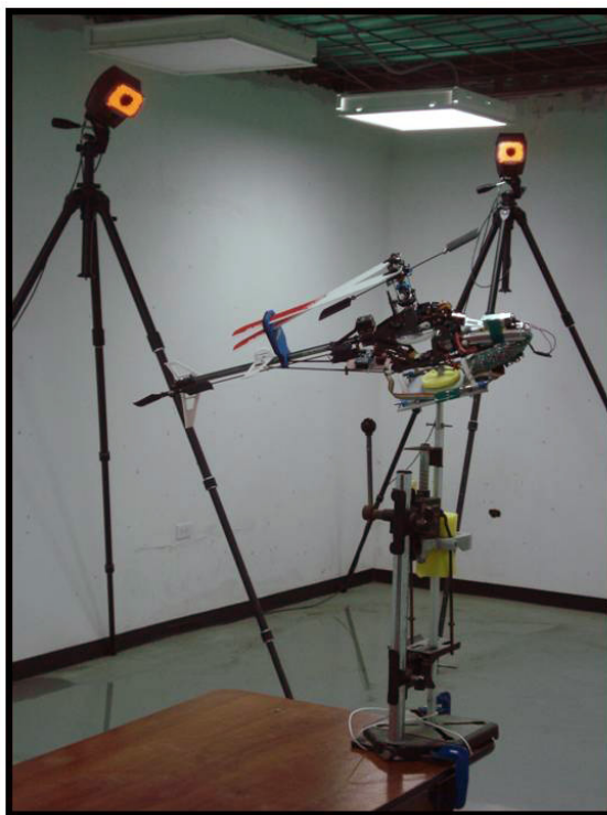
Figura 7.27: Ubicación del helicóptero en el laboratorio de análisis de movimiento, utilizando la estructura de seguridad para roll , pitch , yaw y altura
