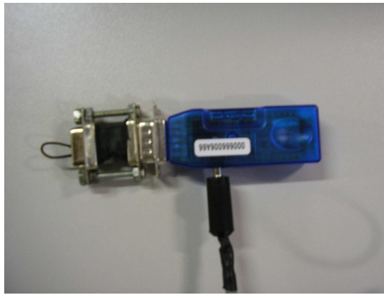
Fig. 4.37: Módulo Bluetooth configurado para ecoar dados automaticamente.
