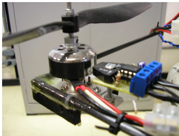
Fig. 2.25: Sensor de rotação acoplado a um motor.
