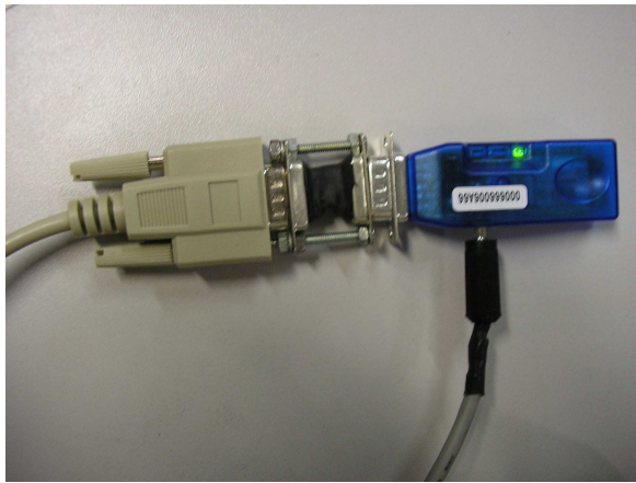
(a) Módulo Bluetooth ligado à porta serial do computador com alimentação via porta USB.
