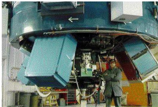
Figura 3.4: c) Immagine raffigurante il "cuore" di UKIRT; in corrispondenza dei quattro punti cardinali sono montati i quattro strumenti a disposizione: UFTI, TUFTI, MAX e CGS4.
