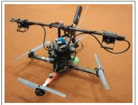
(a) Laser-equipped Quadrotor helicopter
