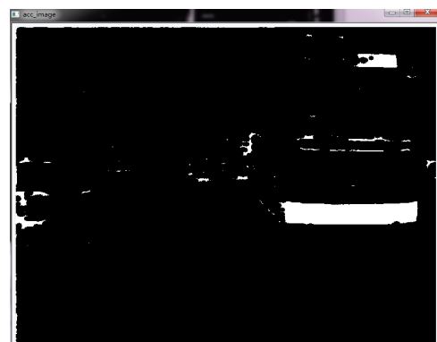
图 3.24 误判图片最后的处理结果。经过所有处理后，巴士的后挡板仍很难与交通标志区分。
