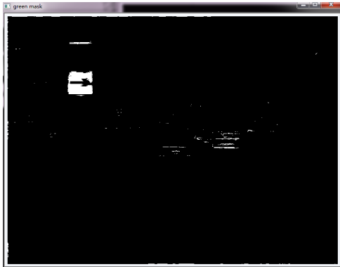
图 3.19 Histogram Equalization后和取与运算后的Mask。白色表示表示在阈值范围内，可能是交通标志的一部分。
