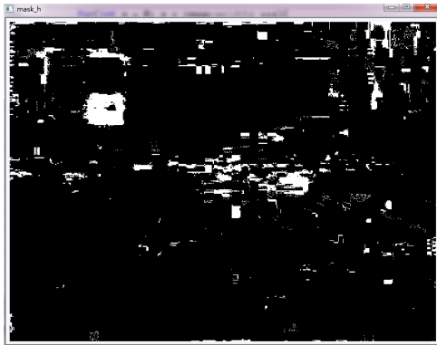
图 3.7 H通道取阈值后的结果。白色表示表示在阈值范围内，可能是交通标志的一部分。
