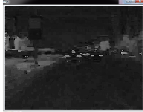
图 3.16 Histogram Equalization后的H通道。白色表示值最大，黑色表示值最小。
