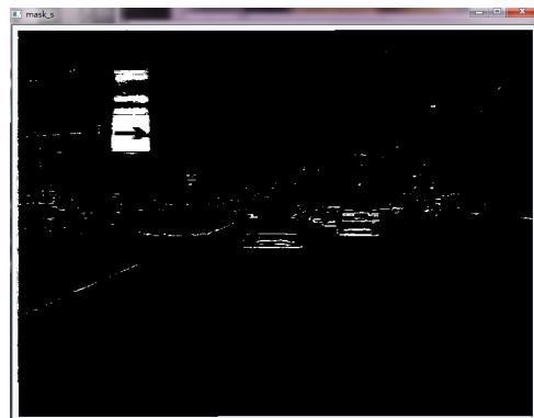
图 3.18 Histogram Equalization后的S通道取阈值后的结果。白色表示表示在阈值范围内，可能是交通标志的一部分。
