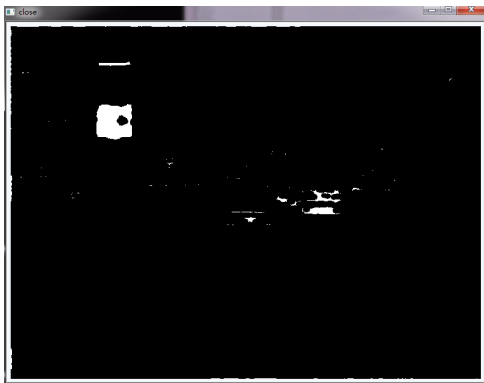
图 3.20 Histogram Equalization后合Close算法处理后的图像。白色表示表示在阈值范围内，可能是交通标志的一部分。
