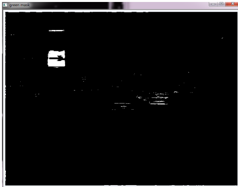
图 3.8 取与运算后的Mask。白色表示表示在阈值范围内，可能是交通标志的一部分。
