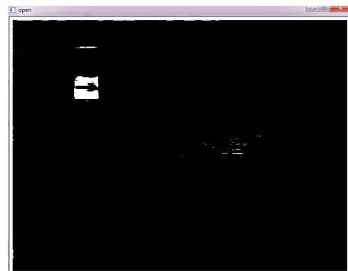
图 3.11 Erode算法处理后的图像。白色表示表示在阈值范围内，可能是交通标志的一部分。
