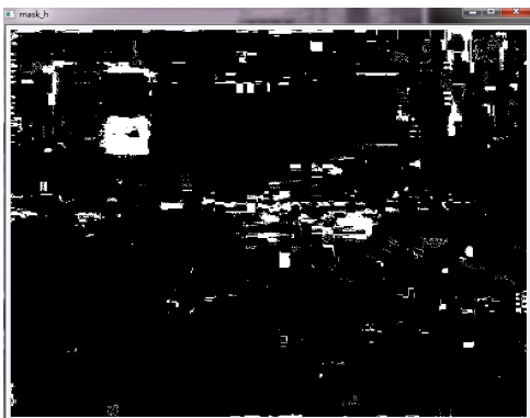
图 3.15 Histogram Equalization后的H通道取阈值后的结果。白色表示表示在阈值范围内，可能是交通标志的一部分。
