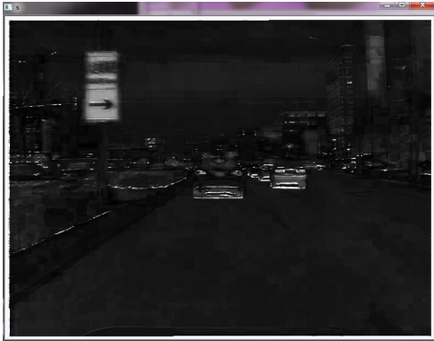
图 3.14 Histogram Equalization后的S通道。白色表示值最大，黑色表示值最小。
